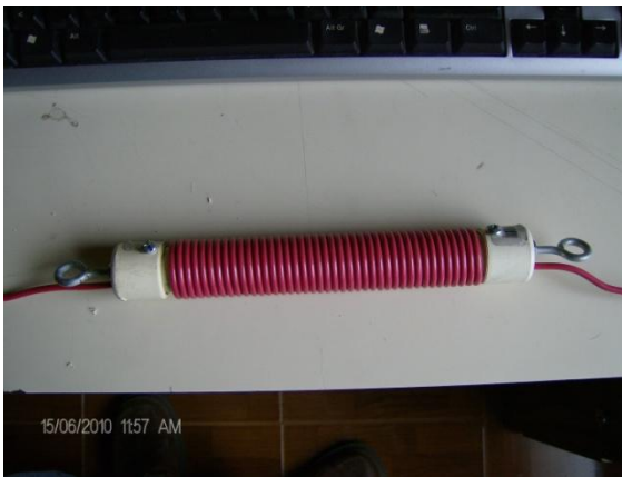
Bobina construida con cable # 16
