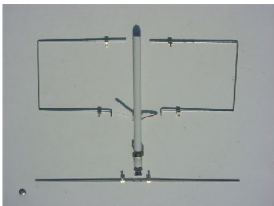
Foto 3: Conector BNC en su posición definitiva
